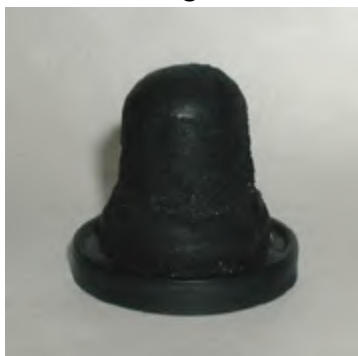
Imagen 01: Ataque químico a diafragma cónico por incompatibilidad de materiales – fluidos, consecuencia de usar una bomba de otro sistema, sin evaluación previa.
