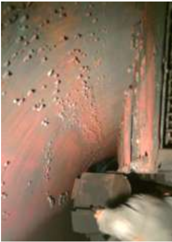
Fotos #1 y 2: Corrosión Localizada por oxígeno - Picadura (pitting) Tambor Superior (vapor)
