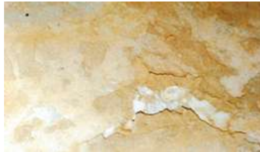
Fotos #1 y 2: Corrosión Localizada por oxígeno - Picadura (pitting) Tambor Superior (vapor)
